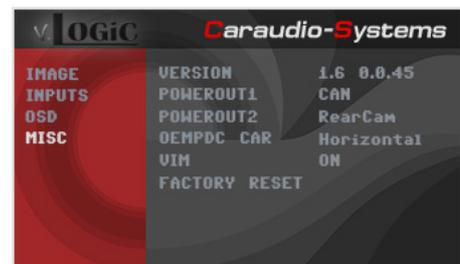
3 Bei einigen Fahrzeugen ist das Rückwärtsgangsignal nicht auf dem CAN-Bus vorhanden. Sollte das System nach der Installation und dem hier beschriebenen OSD-Setup (siehe nächstes Kapitel) nicht automatisch auf die Rückfahrkamera umschalten, so muss das weiße Kabel des Kabelsatzes TV-BM01 an das Rückfahrlichtsignal (+12V des Rückfahrlichts) angeschlossen werden.
