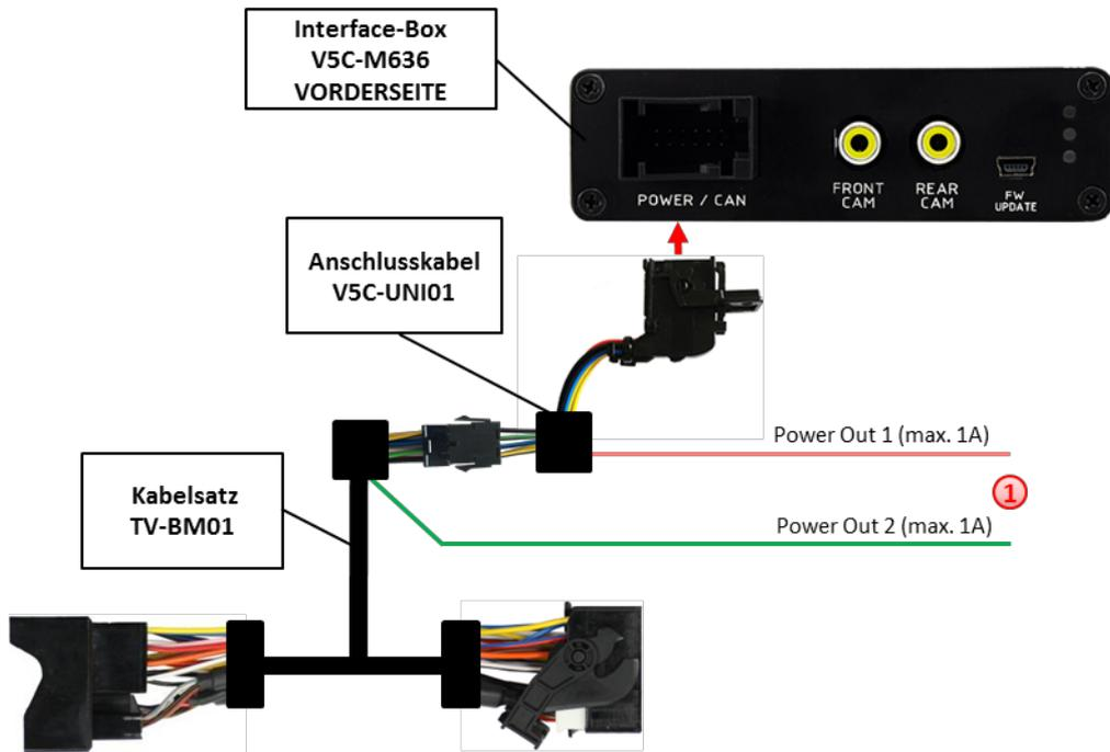
① Die beiden +12V Schaltausgänge (max. 1A) sind einzeln konfigurierbar. Das rosa Kabel ist Power Out 1 und das grüne Kabel ist Power Out 2.
