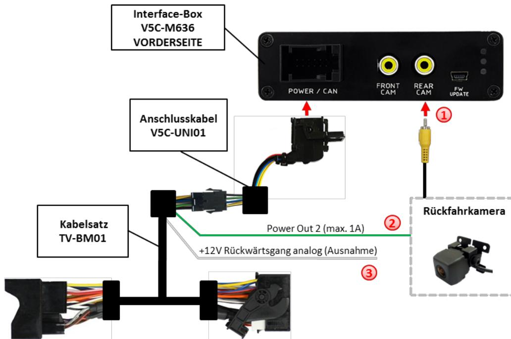
1 Video-Cinch Stecker der After-Market-Rückfahrkamera an der „REAR CAM“ Cinch-Buchse der Interface-Box V5C-M636 verbinden.
