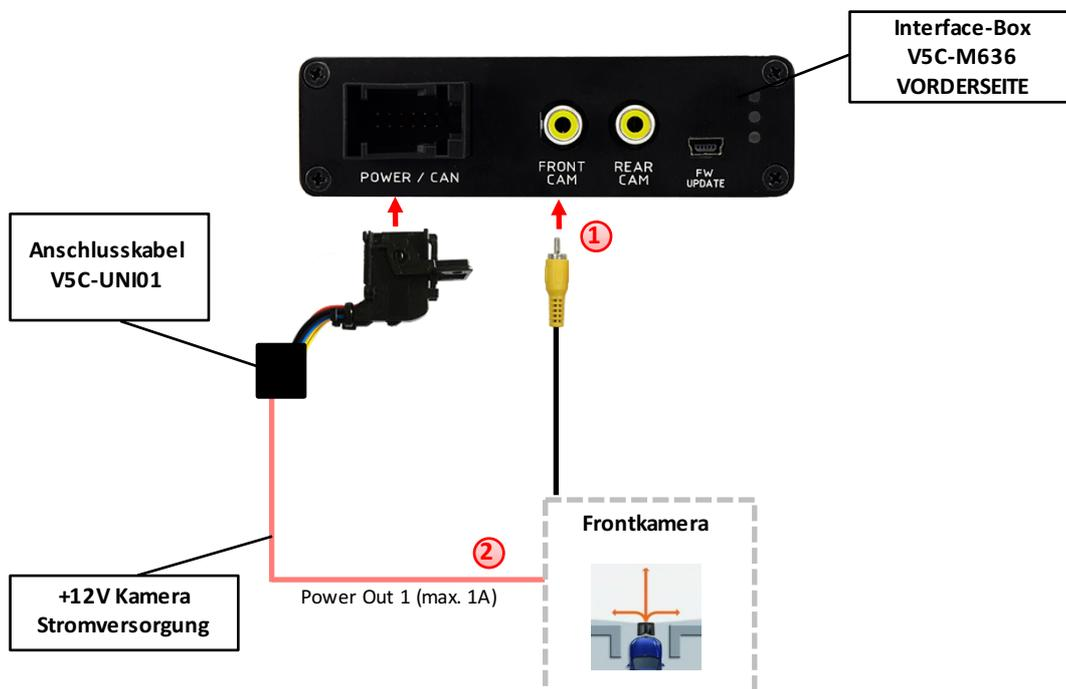
1 Video-Cinch Stecker der After-Market-Frontkamera an der „FRONT CAM“ Cinch-Buchse der Interface-Box V5C-M613 verbinden.
